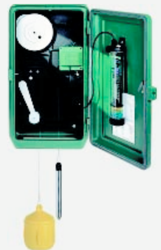
Thalimedes con R 16 limnógrafo registrador vertical
